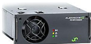
Номер детали 241115.705. Помимо функции высокой эффективности (см. главу Выпрямитель *Flatpack2*, 48 В, 2000 Вт, HE, стр. 13) широкий выходной диапазон постоянного тока выпрямителя (WOR) обеспечивает поддержку никель-кадмиевых и свинцовых аккумуляторных блоков. На контроллере можно настроить от 38 до 40 элементов в никель-кадмиевых аккумуляторных блоках и 24 или 30 элементов в свинцовых аккумуляторных блоках.
