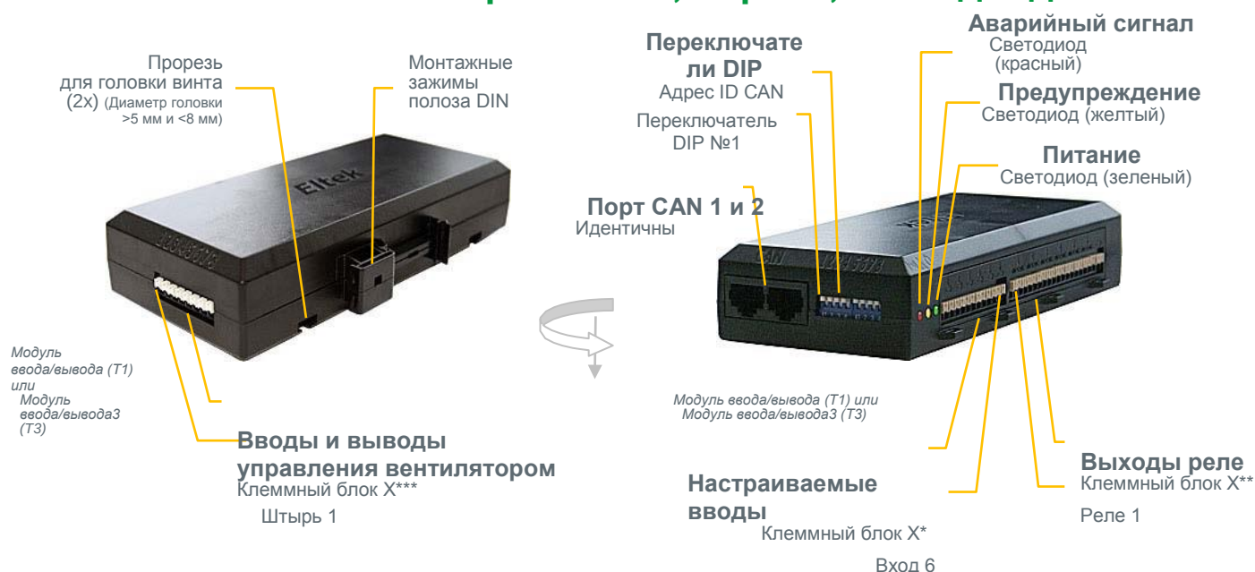
Рисунок 2 Расположение клемм, переключателей DIP, портов CAN и светодиодных индикаторов на модуле ввода/вывода (T1) и модуле ввода/вывода3 (T3)
