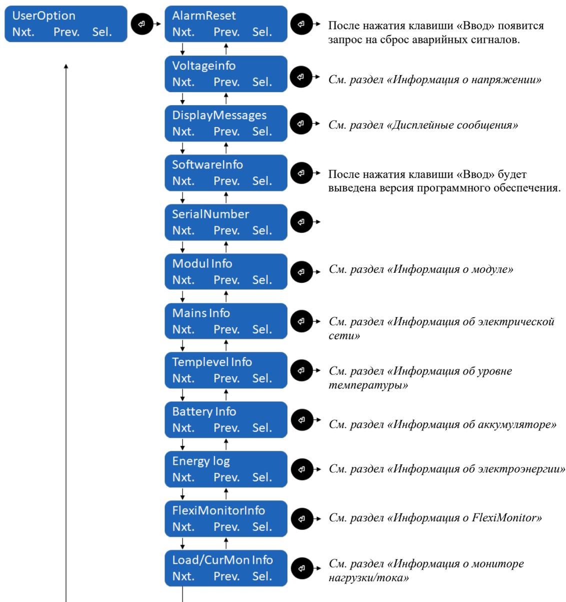
Рисунок 10. Меню «Режима пользователя» на дисплее передней панели
