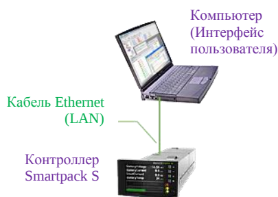
Рис. 5 Пример обновления программного обеспечения контроллера Smartpack S через компьютер
