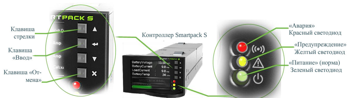
Рис. 4 Клавиши и индикаторы передней панели контроллера Smartpack S
