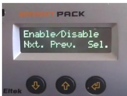
В следующем окне данного подменю MainsFeed (Основной ввод) выставить ток ограничения заряда АКБ (как правило это 10% от полной ёмкости используемой АКБ, если к ЭПУ подключено параллельно несколько групп АКБ, например, 3 группы по 100 Ач, то ток заряда АКБ в течение 10 часов должен быть равен –  $3 \times 100 \text{ Ач} \times 0,1 = 30 \text{ А}$  ).
