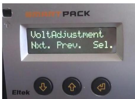
В данном окне выставляется рабочее напряжение системы ( т.е номинальное напряжение указанное производителем АКБ при температуре = 20 ...25 град Ц ).
