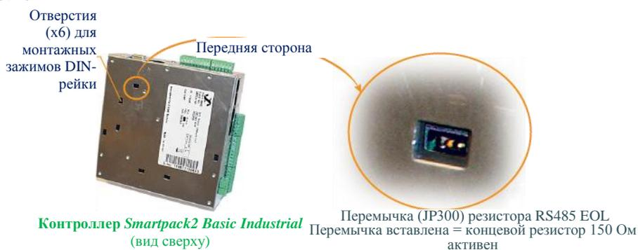
Рисунок 5. Расположение переключки резистора RS485 EOL в контроллере *Smartpack2 Basic Industrial*
