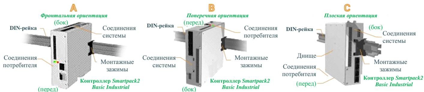
Рисунок 6. Ориентация установки контроллера *Smartpack2 Basic Industrial*
