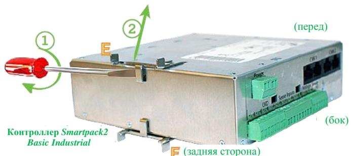
1. Нажмите плоской отверткой между одинарным крючком зажима и контроллером и поверните отвертку, чтобы снять крючок с контроллера.
