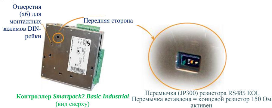
Рисунок 4. Расположение DIP-переключателей и перемычки изоляции в контроллере Smartpack2 Basic Industrial
