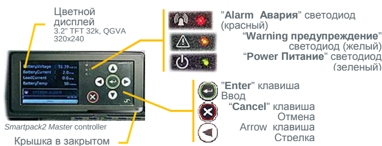
Рис 4 Smartpack2 Master -клавиши и индикаторы передней панели
