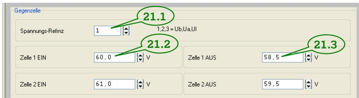
**Gegenzellen** in USV-Anlagen sollen den Verbraucher vor Überspannungen, z. B. während einer Starkladung, schützen. Zuerst wird die Spannungs-Referenz (21.1) (1=U<sub>Batt</sub>; 2=U<sub>Abgriff</sub>; 3=U<sub>Last</sub>) und anschließend die EIN- (21.2) und AUS-Schwelle (21.3) für Zelle 1 und ggf. auch für Zelle 2 festgelegt.
