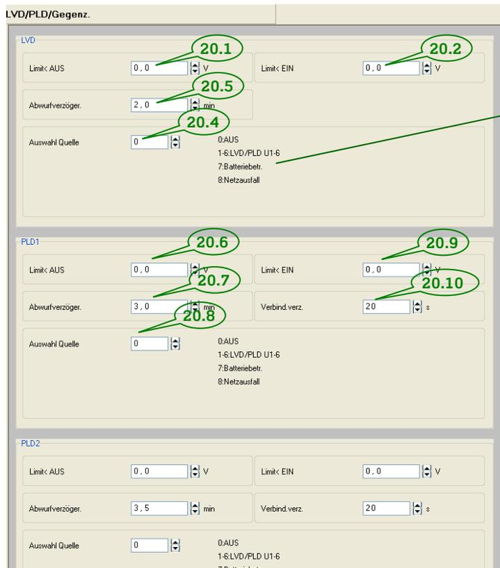
Der Parameter "Auswahl Quelle" (20.4) entscheidet über die generelle LVD/PLD-Funktionalität.
