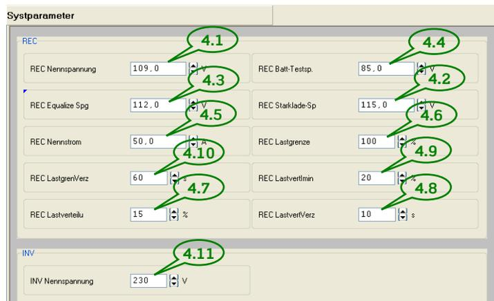
Die "REC Nennspannung" (4.1) entspricht der Normalladespannung (bzw. Batterieerhaltungsladespannung).
