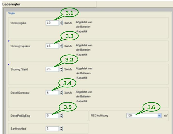
Eine Hauptaufgabe der UPC4 ist es, den Gleichrichtern eine Spannungsvorgabe zu liefern, um Batterien zu laden oder in einem geladenen Zustand zu halten.
