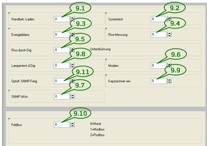
Das Freigeben des Parameters "Handbetrieb Laden" (9.1) ermöglicht das manuelle Steuern der Vorgabespannung der Gleichrichter.
