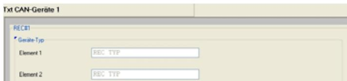
Sämtliche Texte sind nur informativ und können nicht geändert werden. Die UPC4 erhält die Texte automatisch von den angeschlossenen Modulen. In diesem Fall von Leistungsmodulen wie PSR, PSC, INV.
