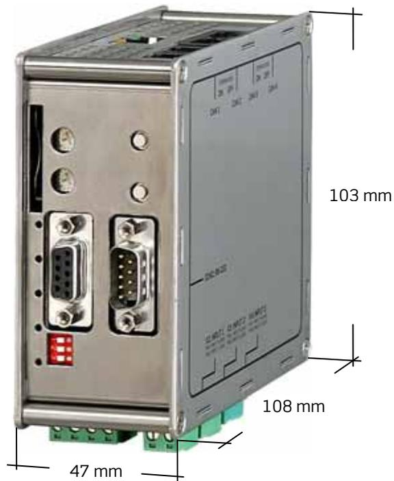
Abb. 8. Abmessungen UPC4
