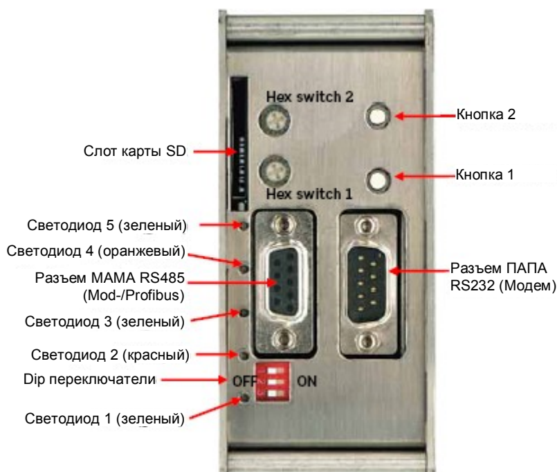
Рис. 3. Разъем модема/Разъем Fieldbus /Слот под карту SD/Светодиодная индикация
